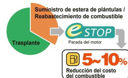
Una simple inclinación de la palanca detiene el motor, lo que evita un consumo innecesario de combustible durante la reposición de la estera de plántulas y contribuye al ahorro de combustible.
