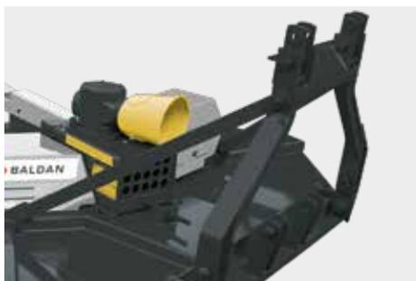
Barra de enganche que permite regular el equipo para trabajos en las posiciones lateral y super lateral.
