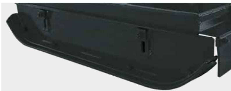
Patines laterales con chapas reemplazables y regulación de altura de corte.
