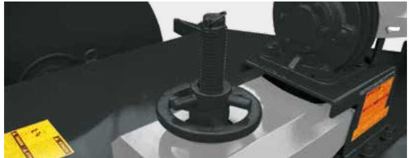
Soporte para la regulación de la altura de corte de las cuchillas, desde 100 hasta 320mm.
