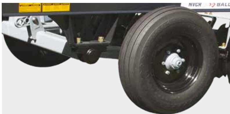
NVCR 28 al 44 discos neumáticos simples 600 x 16. NVCR 48 al 56 discos neumáticos simples 7.50 x 16.
