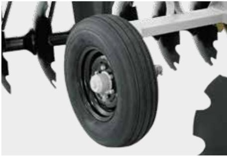
Standard: ruedas simples con neumáticos 7.50 x 16 para los modelos CRI 12 hasta 30 discos.
