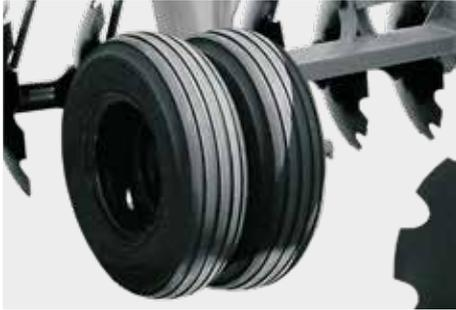
Standard: ruedas dobles con neumáticos 7.50 x 16 para los modelos CRI 32 - 44 discos.
