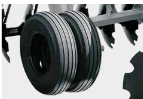
Ruedas dobles con neumáticos 7.50x16 para los modelos CRSG 32 - 48 discos.
