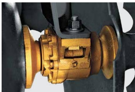
Cojinetes de rodamientos cónicos a grasa o en baño de aceite con lubricación permanente con protección.
