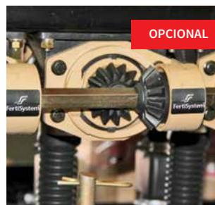
Conductor de abono sistema FertiSystem transversal.
