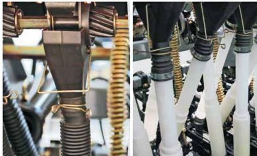
Sistema de distribución de semillas a través de rotores y conductores especiales para la distribución de abono y semilla.
