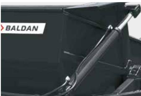
Sistema de basculamiento a través de pistón hidráulico.
