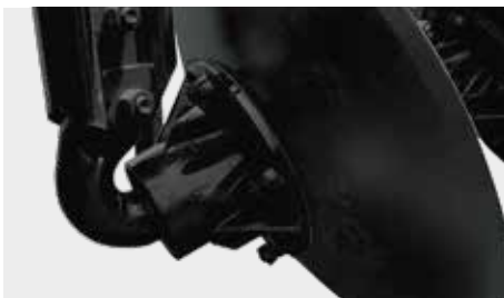
Maza de los discos con rodamientos cónicos con grasa.
